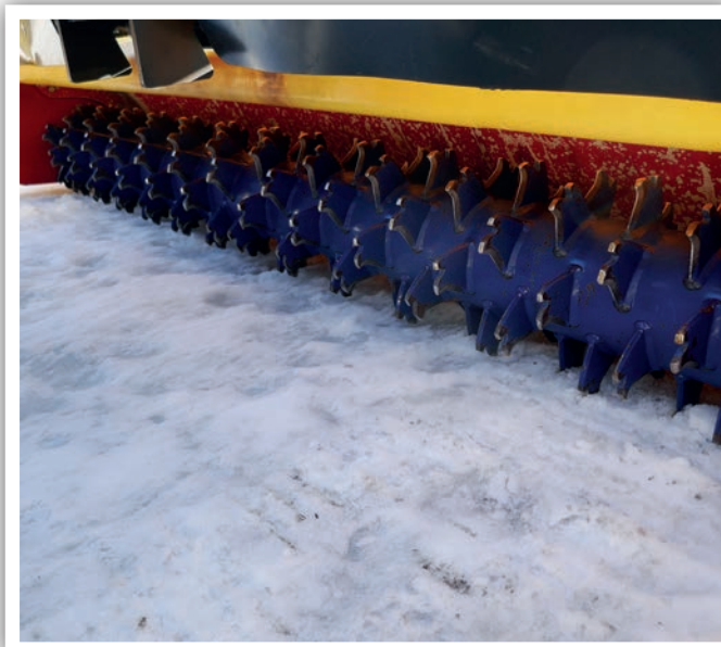
Die Fräse lockert den frischen Schnee oder bestehende Spuren auf.
