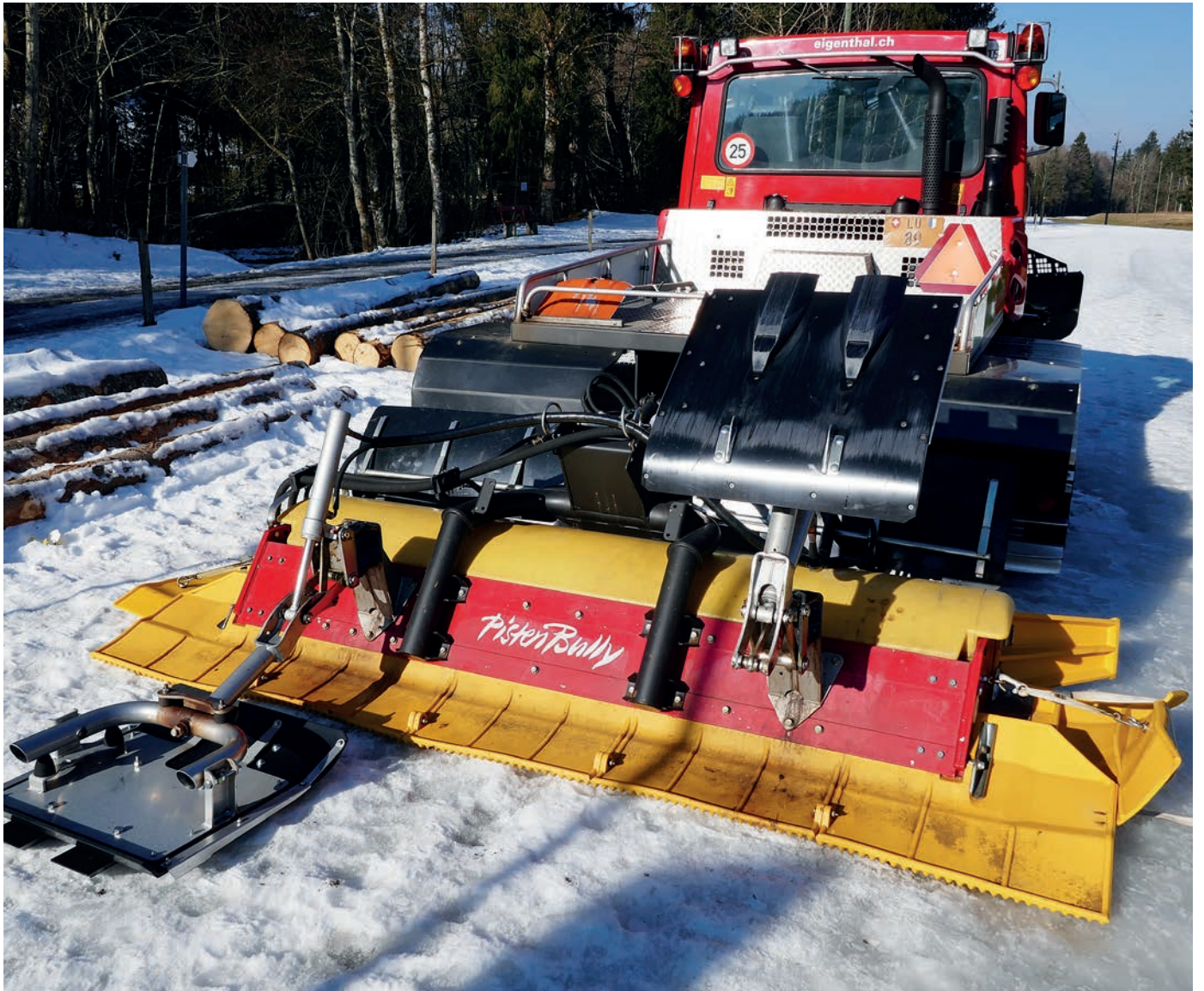
Der gelbe Finisher wälzt den durch die Fräse aufgelockerten Schnee. Die Spurplatten können zusammen oder einzeln eingesetzt werden.
