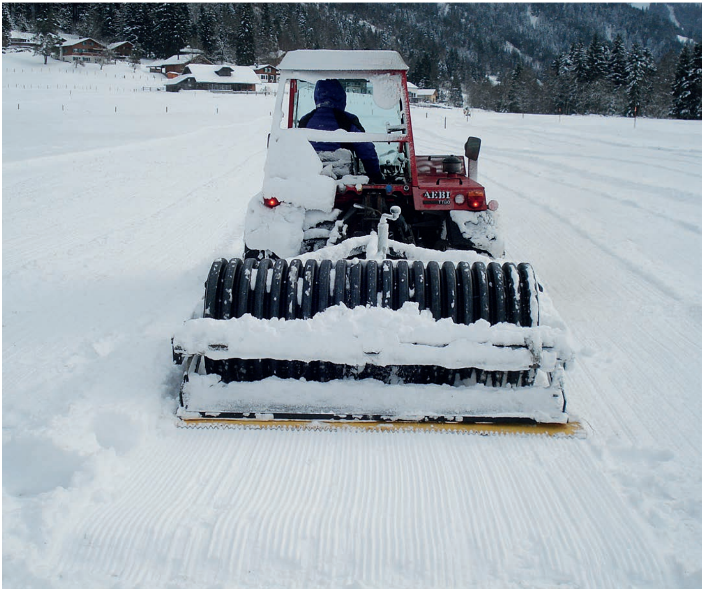
Bei geringer Schneehöhe kommt die Walze zum Einsatz, die von einem Traktor gezogen wird. Damit kann jedoch nur die Skatingloipe präpariert werden.
