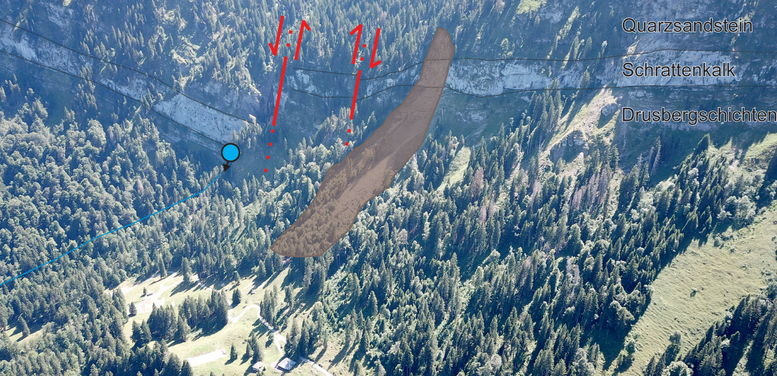
Abb. 4: Drohnenaufnahme der Blattenfluh und der darunterliegenden Schutthalde. Vor rund 50 Jahren löste sich hier aus dieser Felswand ein beachtlicher Felssturz. Herunterstürzende Blöcke kamen erst im Talboden zu liegen. Östlich angrenzend sind die hellen Schrattenkalk-Gesteine an zwei Störzonen sichtlich verschoben. An der einen Störzone entspringt die ergiebige Bründlenquelle, deren Wasser die Stadt Luzern seit 1875 versorgt (LORENZ et. al. 1991). Blickrichtung Südost.
